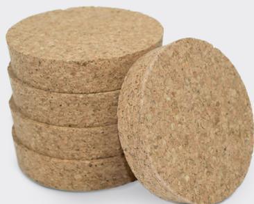
Die effektive Lösung zum Verschließen von Einblasöffnungen in mineralischen Platten oder Holzwerkstoffen, wie OSB, Holzweichfaser-, Gipskarton- und Gipsfaserplatten. Die konisch geschnittene Korkscheibe kann mit herkömmlichen Spachtel- und Putzmassen abgedeckt werden. Damit werden auch die Anforderungen an die Luft- und Winddichtheit erreicht.
